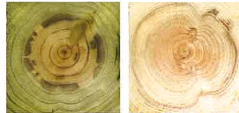
左・加圧注入薬剤の浸透状態：木材の辺材部分まで深く浸透 右・薬剤を塗布した後の浸透状態：木材の表面部分のみ浅く浸透
