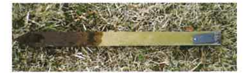
加圧注入処理を施した「緑の柱」を地面に刺した状態で29年経過したものの腐れなどの損傷はみられない。
